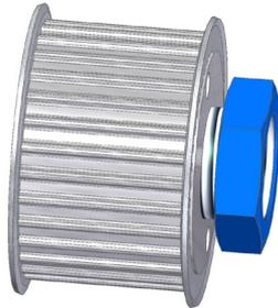
Abb.: 10 Befestigungsmutter um 2 - 3 Umdrehungen gelöst
